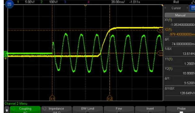
CH1 : Output Voltage CH2 : AC Input Voltage
